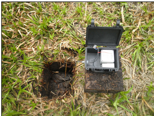
Foto 2: Příklad uložení ústředny zařízení v úložném boxu.
